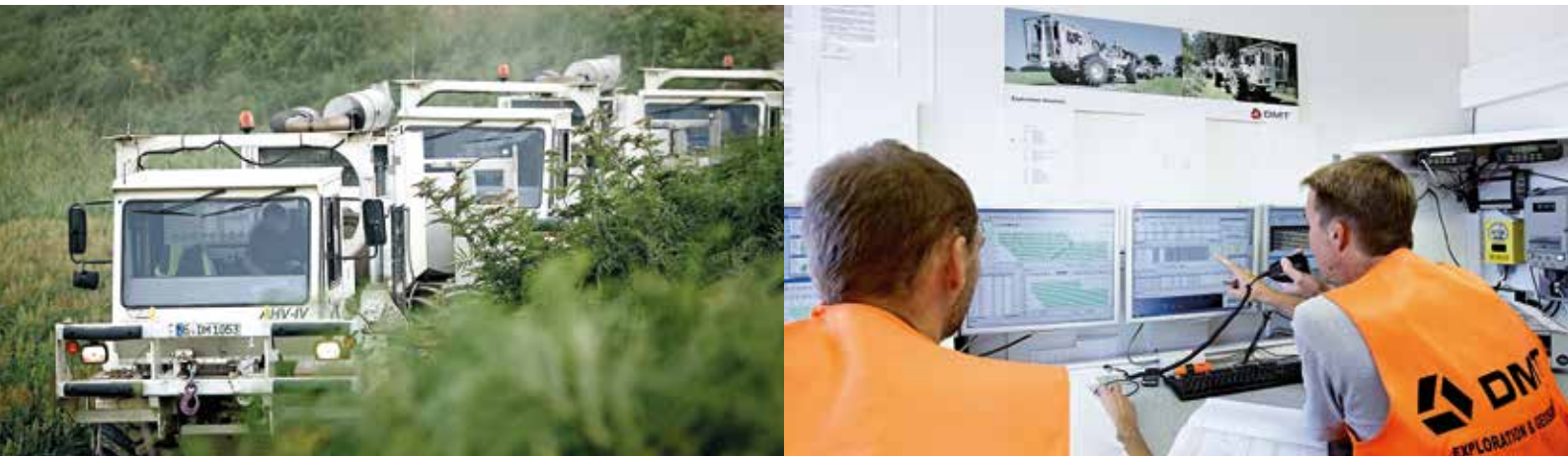
Campagne sismique : vues de l'extérieur et de l'intérieur d'un camion vibreur.
