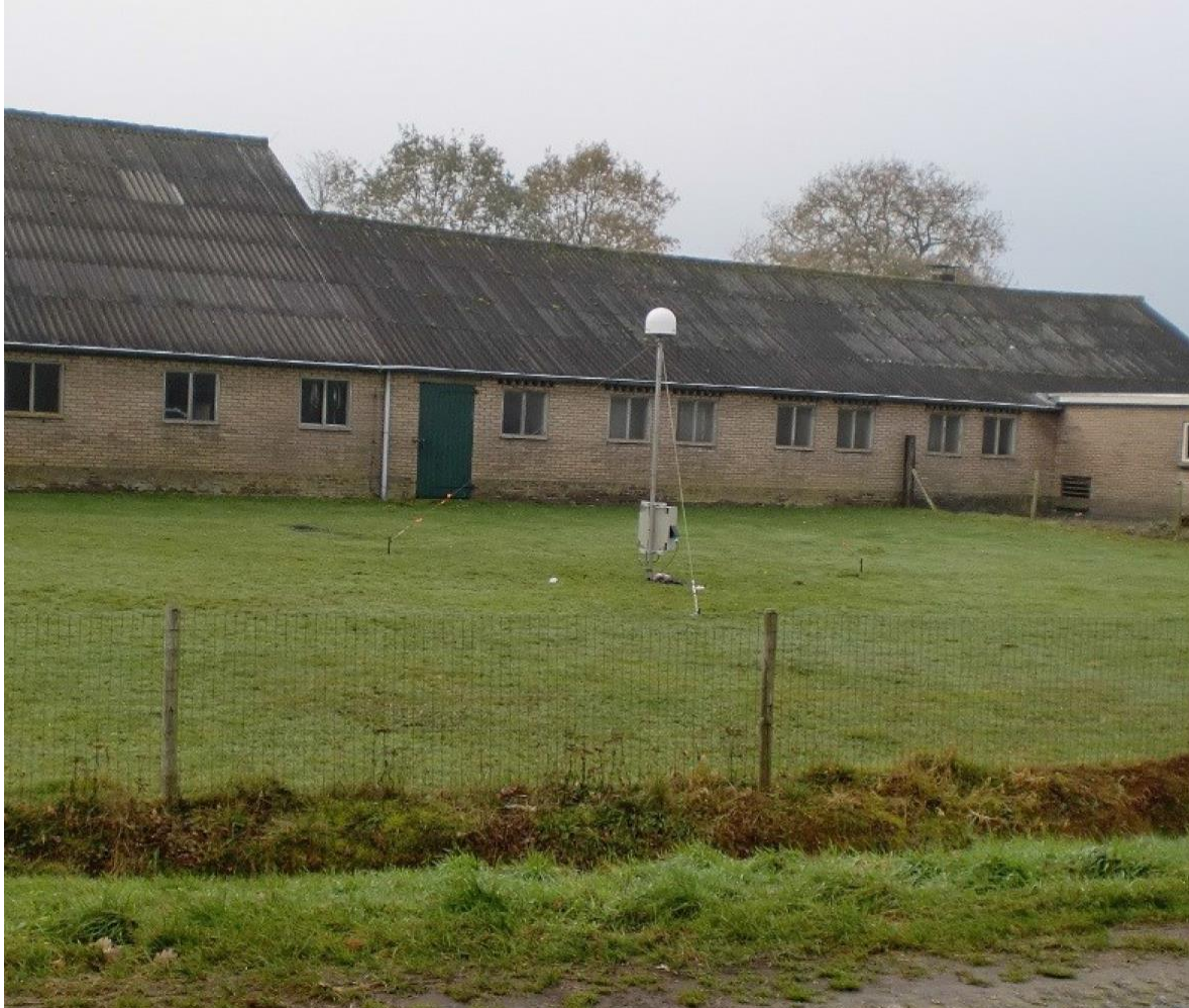
Figuur 2-7 Tijdelijk GPS station zoals gebruikt bij een regelmatige GPS meting
