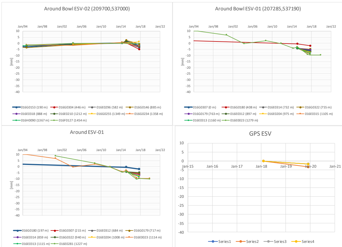
Figuur 16-12 Resultaten van de GPS meting op de Eesveen locatie (rechtsonder; de GPS metingen zijn daar in 2018 begonnen). De andere drie grafieken geven de waterpassingen weer op de Eesveen locatie (linksonder), en de geschatte diepste punten van de Eesveen-01 en Eesveen-02 dalingskommen..
