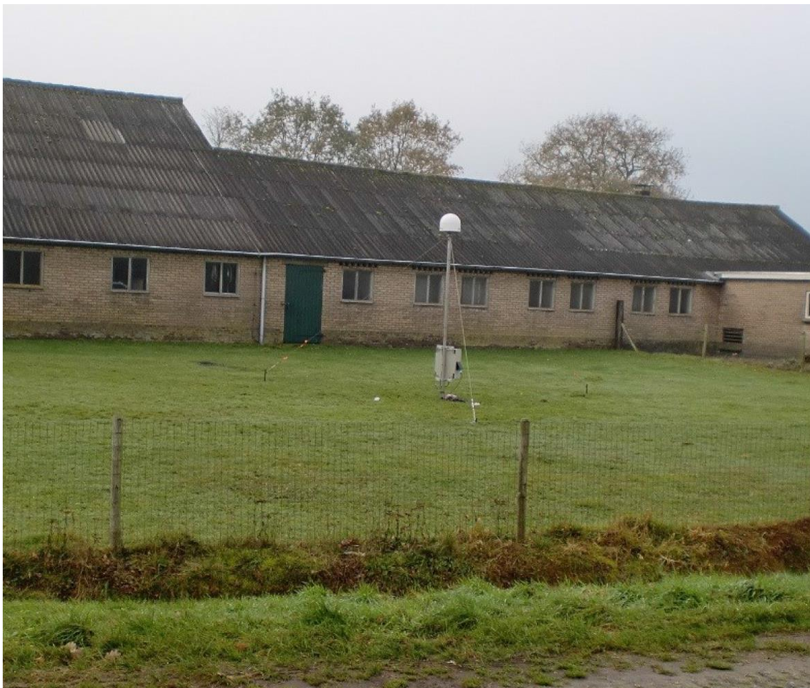
Figuur 2-5 Tijdelijk GPS-station zoals gebruikt bij een regelmatige GPS meting
