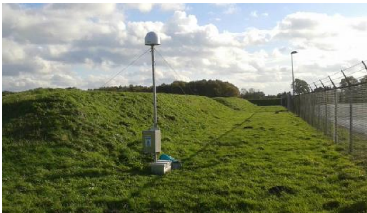
Figuur 2-10: Tijdelijk GPS-station zoals gebruikt bij een regelmatige GPS-meting.
